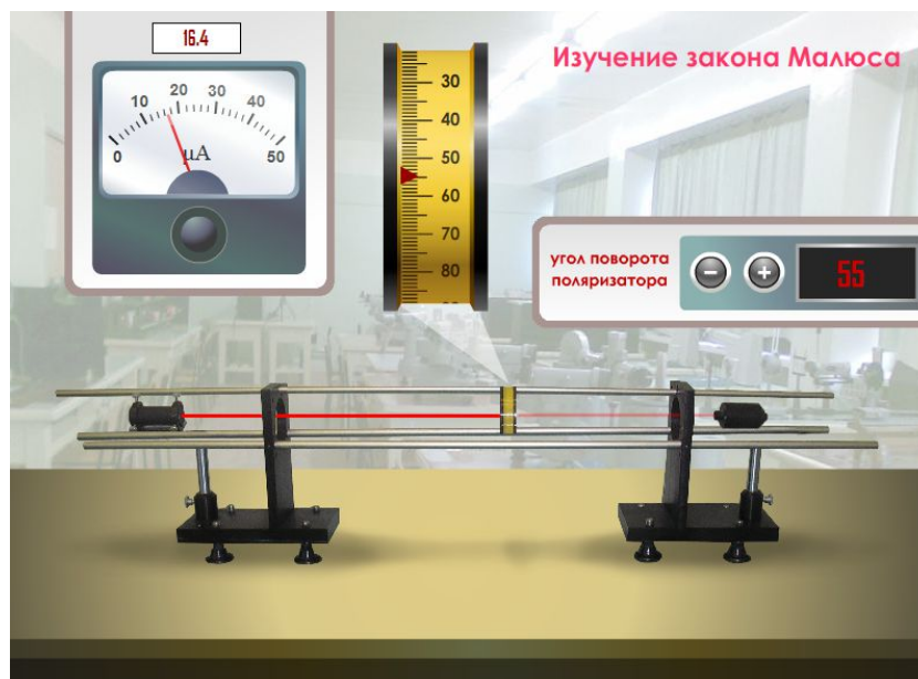
Рис. 5. Интерактивная электронная установка для изучения закона Малюса
