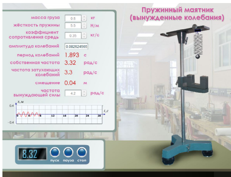
Рис. 4. Интерактивная электронная установка для изучения вынужденных колебаний
